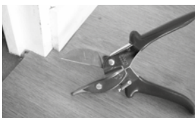
Cisaille à ongle Référence : ROMUS : 93415 / JANSER : 237 530 000. Pour découpe autour des pieds d'huisserie, endroits difficiles d'accès.
